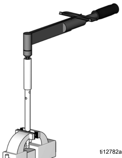
Rys. 2. Zdejmowanie nakrętki przepływowej
