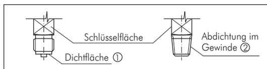
Das Anzugsmoment ist von der eingesetzten Dichtung abhängig. Um das Messgerät in die Stellung zu bringen, in der es sich am besten ablesen lässt, ist ein Anschluss mit Spannmuffe oder Überwurfmutter zu empfehlen. Sofern ein Druckmessgerät eine Ausblaskvorrichtung besitzt, muss diese vor Blockierung durch Geräteteile oder Schmutz geschützt sein. Bei Sicherheitsdruckmessgeräten (zu erkennen am Ⓢ) ist darauf zu achten, dass der Freiraum hinter der ausblasbaren Rückwand mindestens 15 mm beträgt.
