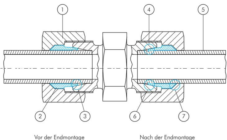
Beim Anziehen presst die Überwurfmutter (1) den Schneidring (2) in den Innenkegel (3) des Verschraubungsstutzens. Hierdurch schneidet die gehärtete Kante (4) des Schneidringes (ungehärtet bei NC-Verschraubungen) in das Rohr (5) ein. Vor der Schneidkante wirft sich das Rohrmaterial zu einem deutlich sichtbaren Wulst (6) auf. Der Schneidring wird gleichzeitig mutterseitig auf dem Rohr verkeilt (7) und bietet so zusätzlichen Halt.
