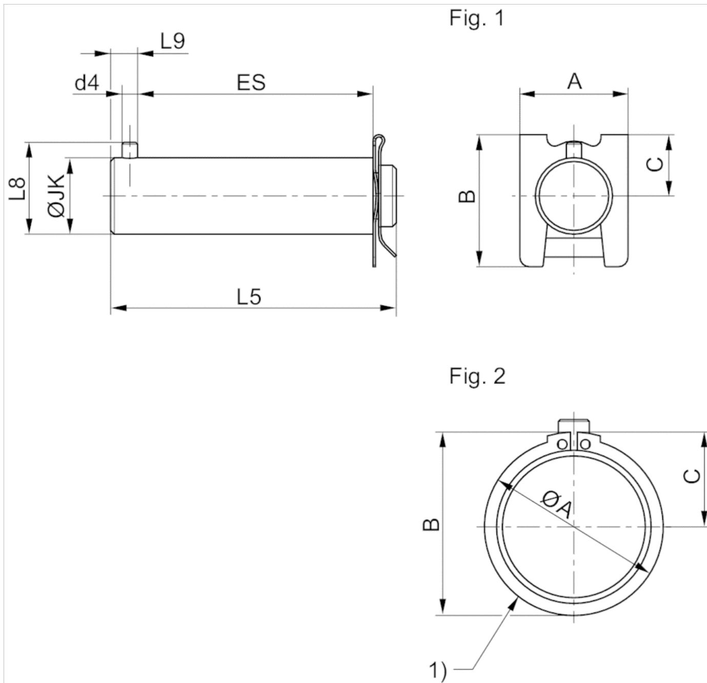
1) Sicherungsring DIN 471
