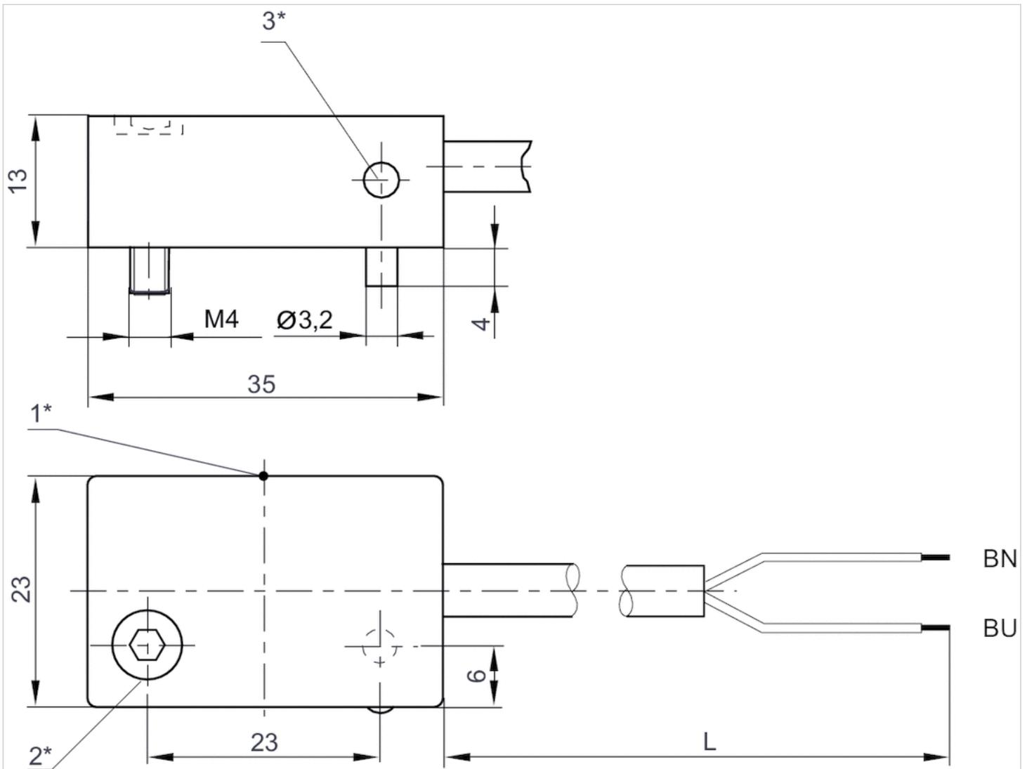
1\* = Schalterpunkt 2\* = Klemmschraube 3\* = LEDL = Kabellänge
