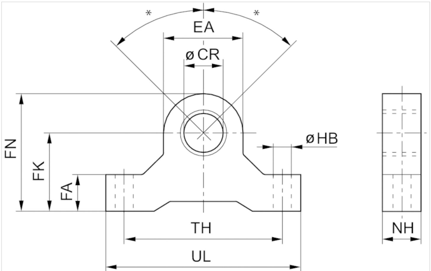
\* Max. Pendelbewegung für Zylinder mit Gegenlager MP6 mit sphärischem Gelenklager:  $\pm 45^\circ$
