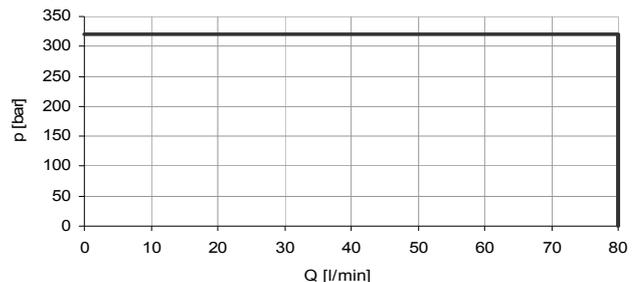
Die Schaltleistungsgrenze wurde mit betriebswarmen Magneten und 10% Unterspannung ermittelt. Die angegebene Schaltleistungsgrenze ist für den Einsatz mit zwei Volumenstromrichtungen gültig. Bei nur einer Volumenstromrichtung, kann die Schaltleistung geringer sein. Einschränkung der Schaltleistung für Spulen G96/G205: der im Diagramm angegebene max. zul. Volumenstrom ist um 10% zu verringern. Die Schaltzeiten sind verlängert.
