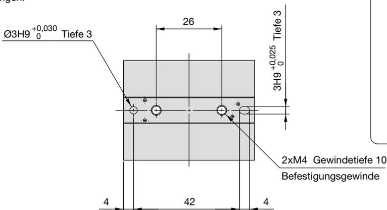
\*Verwenden Sie die beiliegenden Innensechskantschrauben für die Montagebohrungen.
