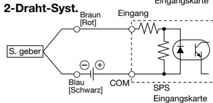
**Spezifizierung für Anschluß an SPS mit COMMON Minus**
