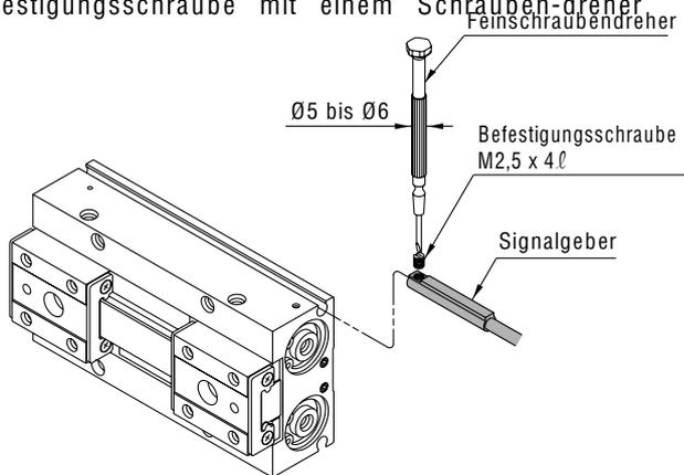
Anm.) Der Schraubendreher zum Festziehen der Befestigungsschraube soll einen Griffdurchmesser von 5 bis 6 mm haben. Das Anzugsdrehmoment muss zwischen 0,05 und 0,1N·m liegen. Dies wird im Allgemeinen mit einer Drehung um 90° ab dem Punkt, an dem ein Widerstand zu spüren ist,
