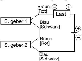
Wenn zwei Signalgeber in Serie geschaltet sind, können Störungen auftreten, da die Betriebsspannung im eingeschalteten Zustand abnimmt. Die LEDs leuchten auf, wenn beide Signalgeber eingeschaltet sind.
