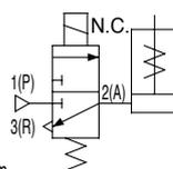
④ Als Vorsteuerventil für luftbetätigte Ventile für Flüssigkeiten
