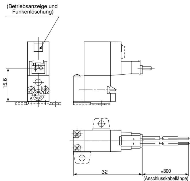
M-Steckdose (M): SY1<sub>2</sub><sup>1</sup>/<sub>3</sub> (A)-□M□□-PM3 (-F)-Q
