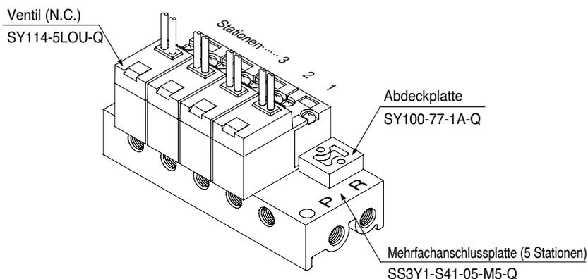
**SS3Y1-S41-05-M5-Q** ..... 1 Stk. (Mehrfachanschlussplatte Typ S41, 5 Stationen)
