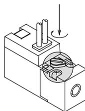
(Durch Drücken wird das Ventil betätigt. Durch Drehen der Handhilfsbetätigung in Pfeilrichtung, während diese gedrückt gehalten wird, kann in dieser Position verriegelt werden. Ohne Drehbewegung hat sie die gleiche Funktion wie die der nicht verriegelbaren Ausführung.)
