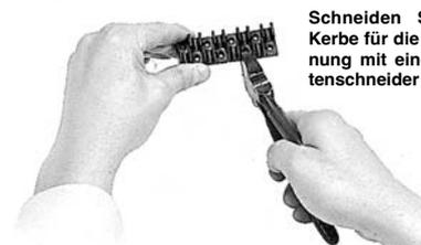
Schneiden Sie die Kerbe für die Abtrennung mit einem Seitenschneider durch.
