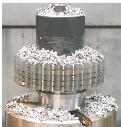
Nakrętka mocująca do zaciskania kół łańcuchowych przy obróbce frezarskiej
