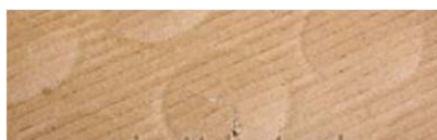
Ilustracja 3 - Typowe ślady/uszkodzenia przez przyssawkę na pudle z blachy falistej.
