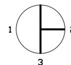
ACTIONNEUR SIMPLE EFFET : Fermeture dans le sens horaire,
